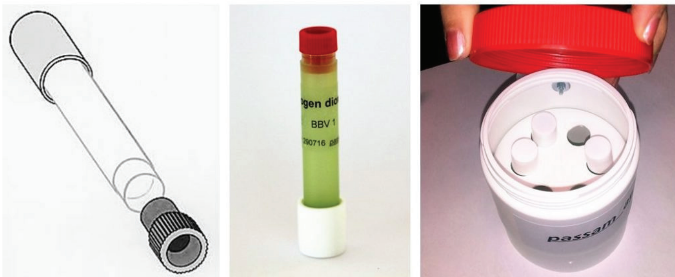
Rysunek 1: Zdjęcie przedstawia próbnik pasywny wykorzystany w pomiarach. Źródło: Passam AG.
